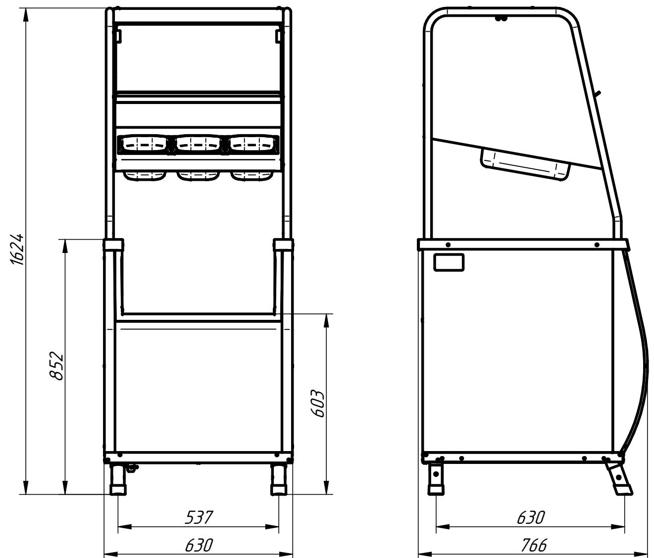
Прилавок столовых приборов и подносов предназначен для раздачи потребителям столовых приборов и подносов в составе линии раздачи. Прилавок имеет три нержавеющих емкости для столовых приборов. Над прилавком установлена полка для нарезанного хлеба. Прилавок имеет регулируемые по высоте ножки.
